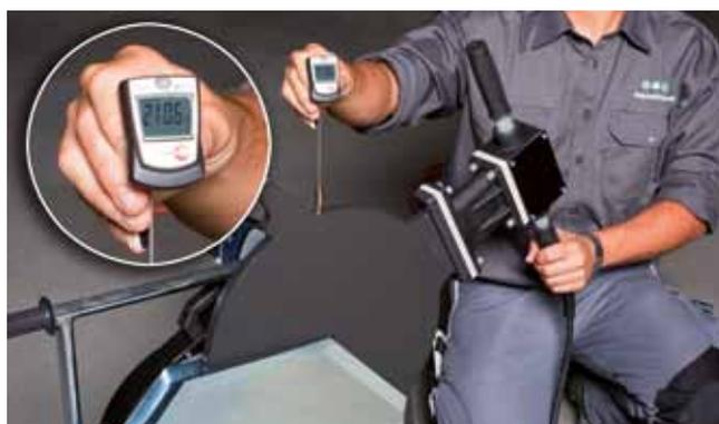
Medida de temperatura en un equipo para soldar a tope
