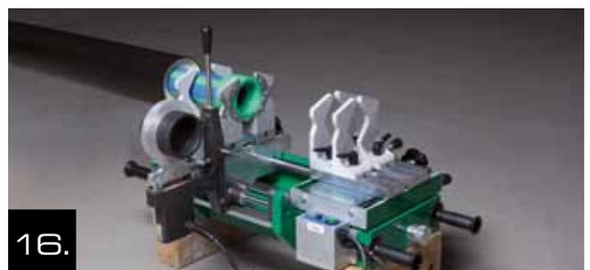
16. Después de que el tiempo de enfriamiento libere las mordazas de sujeción del final de la tubería y del accesorio y gire la máquina de soldar 180 °.
