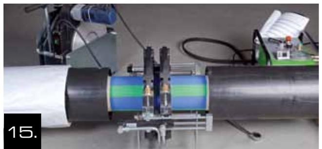
15. La presión de soldadura se mantendrá en el carro de la máquina hasta el final del período de enfriamiento.
