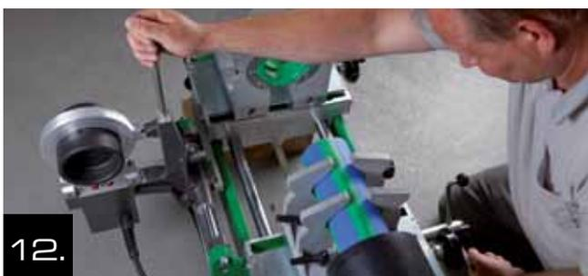
12. Desplace el carro de la máquina de soldadura con la manivela y saque el botón para ajustar la longitud de soldadura
