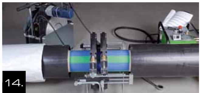
14. Utilizando el sistema hidráulico, unir los extremos del tubo poco a poco hasta que se alcanza la presión de soldadura requerida.
