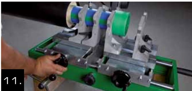
11. Fije el extremo del tubo con las mordazas de sujeción, girando la manivela.
