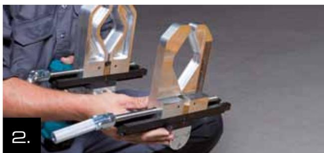
2. Ajustar el diámetro de los trinquetes laterales de la mordaza posterior y fijarlo con el cierre.
