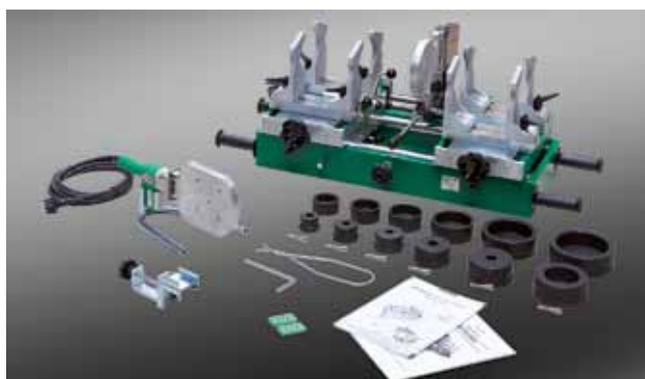
Equipo para soldar (1.400W), con matrices de soldadura.
