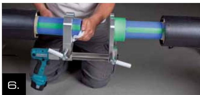
6. Eliminar la suciedad y las impurezas del extremo del tubo y del interior del accesorio.
