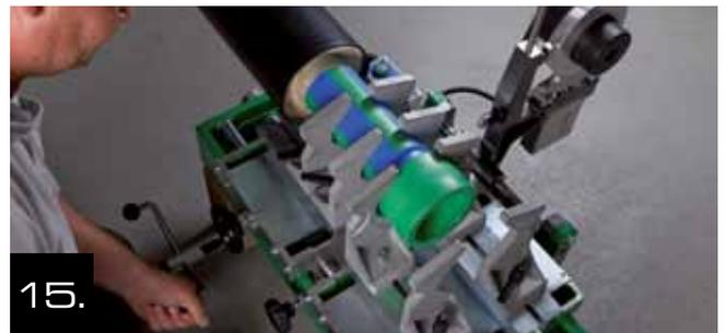
15. Una, hasta el tope, los carros de la máquina de soldadura con la manivela.
