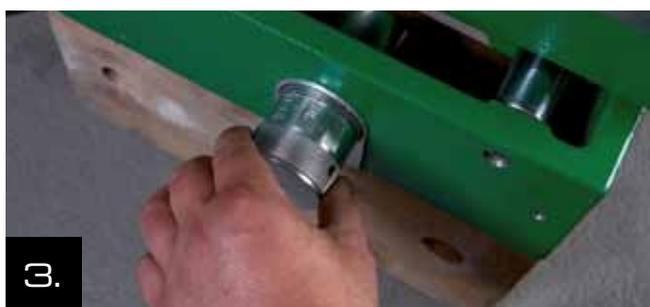
3. La longitud de soldadura necesaria para cada una de las dimensiones de tubería, se ajusta con el selector, que está situado en el lado izquierdo de la máquina.
