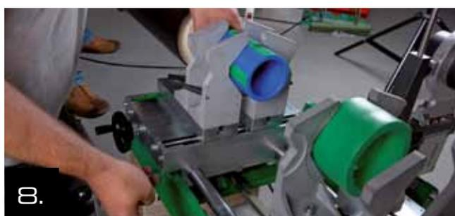
8. Para el ajuste de la profundidad de soldadura pulse hasta el fondo el botón de calibración en el centro del bastidor máquina.
