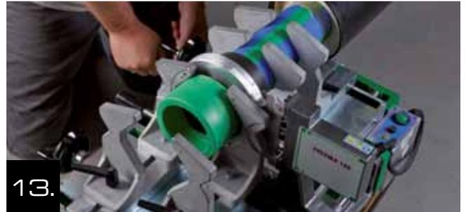
13. Gire hacia abajo la placa de soldar; una los carros de la máquina de soldadura con la manivela.
