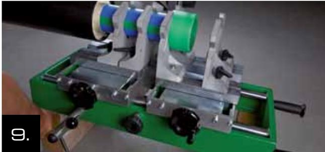
9. Desplace el carro de la máquina de soldadura con la manivela y presione el extremo del tubo contra el manguito.
