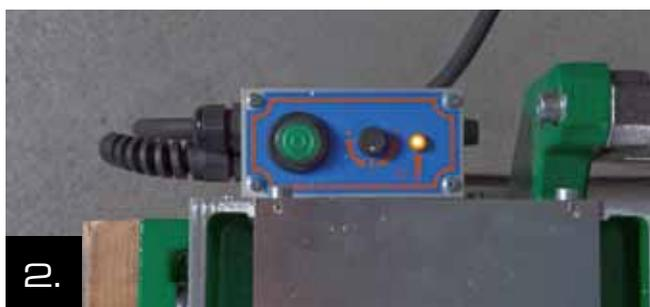
2. Conecte el aparato y compruebe si la lámpara de operación está en amarillo.
