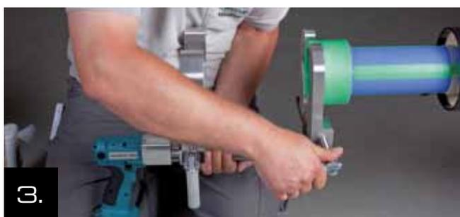
3. Presione las mordazas con el accesorio y apriete con los tornillos de fijación.
