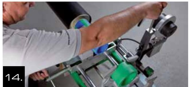
14. Después del tiempo de calentamiento, desplace los carros de la máquina de soldadura con la manivela y eleve el dispositivo de soldadura.
