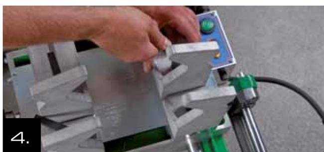
4. Para la unión de tubería, empujar el par posterior de mordazas de la parte delantera y fijarlo apretando los tornillos de fijación.
