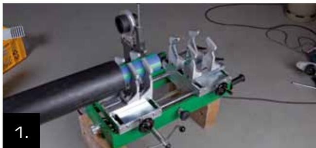
1. Posicione y alinee la máquina de soldar. Utilice un lugar adecuado!. (Tenga en cuenta que la máquina debe ser retirada por debajo de la tubería al terminar el trabajo de soldadura.)
