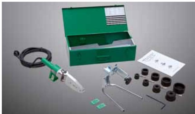
Soldador (800W), con matrices de soldadura de 32 a 63 mm.
