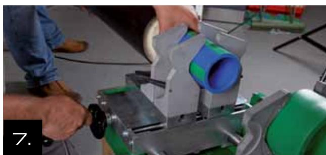
7. Empuje el extremo del tubo entre las mordazas de sujeción y céntrelo girando la manivela, pero no atornille con firmeza.
