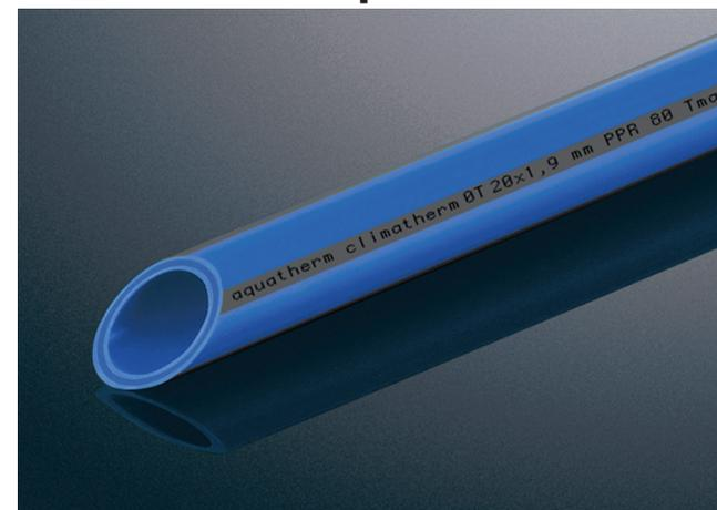
La tubería compuesta **climatherm faser OT** ha sido desarrollada para su aplicación en circuitos cerrados con una barrera exterior impermeable al oxígeno, con la finalidad de prevenir los fenómenos de corrosión de los diferentes elementos metálicos en las instalaciones, tal como indica el RITE 2007 en su IT 1.3.4.2.11 y la UNE 112076:2004 IN.
