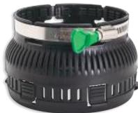
El diseño de esta pieza permite realizar una unión segura entre tuberías, evitando que estas puedan soltarse por flotabilidad del tubo en caso de ser embebido en el hormigón o por arrastre del agua en colectores vistos en las plantas inferiores.
